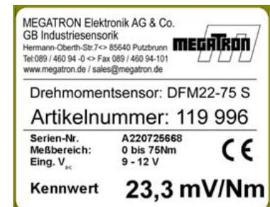
V<sub>out(max)</sub> and V<sub>out(min)</sub> werden durch die Steigung jedes einzelnen Sensors bestimmt, d.h. der Ausgang kann zwischen 0,5 und 4,5V liegen. Der genaue Signalausgangsbereich hängt allerdings vom Kalibrierwert ab.
